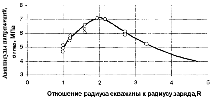
Рис.3. Зависимость амплитуды волны напряжений от величины радиального зазора.
